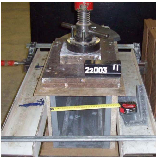
Abbildung 4: Betonrinne aus UHPC bei der Prüfung gemäß ÖNORM EN 1433 (Foto: BTI)
