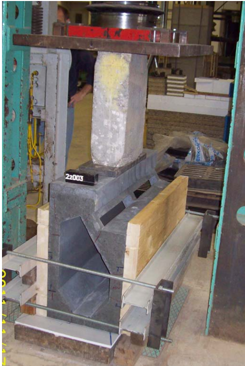
Abbildung 3: Bordschlitzrinne aus UHPC bei der Prüfung gemäß ÖNORM EN 1433 (Foto: BTI)
