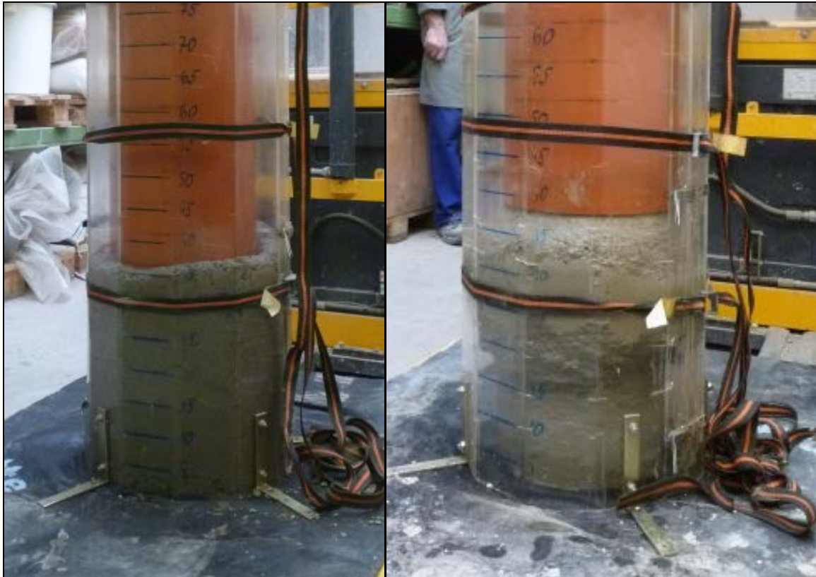
Abbildung 1: Darstellung des Nachfließverhaltens im Labormaßstab mittels Bohrpfahlsimulationsgerät
