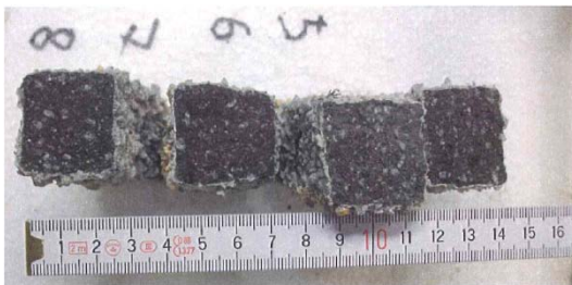
Abbildung 1: Probekörper nach Bestimmung der Resttragfähigkeit in Anlehnung an ÖNORM B 4710-1, Anhang K ( \text{pH} \leq 2,5 ); links: UHPC, rechts: Vergleichsbeton (Fotos: bpv)
