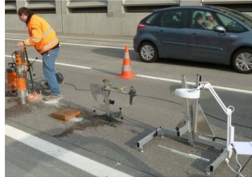
**Abbildung 1:** Typischer Griffigkeitsabfall im Bereich eines Verkehrstunnels, sowie Probenahme zur Ursachenforschung
