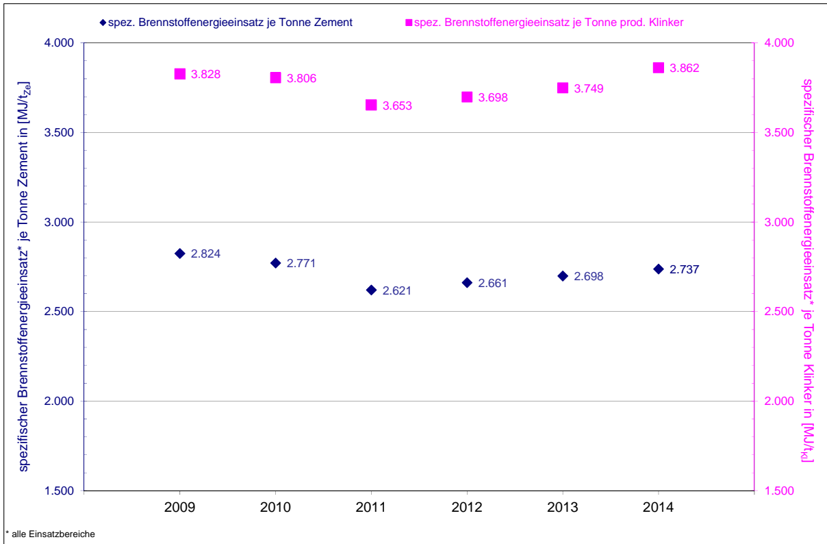
Abbildung 3-9: auf die Tonne Zement bzw. auf die Tonne Klinker bezogener spezifischer Brennstoffenergieeinsatz in Anlagen der österreichischen Zementindustrie für den Beobachtungszeitraum 2009 bis 2014
