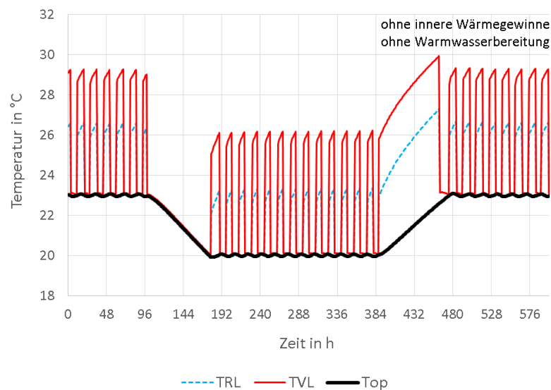
Abbildung 6: Darstellung des Auskühlverhaltens und des Aufheizverhaltens unter synthetischen Randbedingungen ohne innere Lasten und rückgewinnbare Anlagenverluste sowie des Taktverhaltens der Wärmepumpe unter diesen Bedingungen (TRL=Bauteil-Rücklauftemperatur; TVL=Bauteil-Vorlauftemperatur; Top=operative Temperatur)
