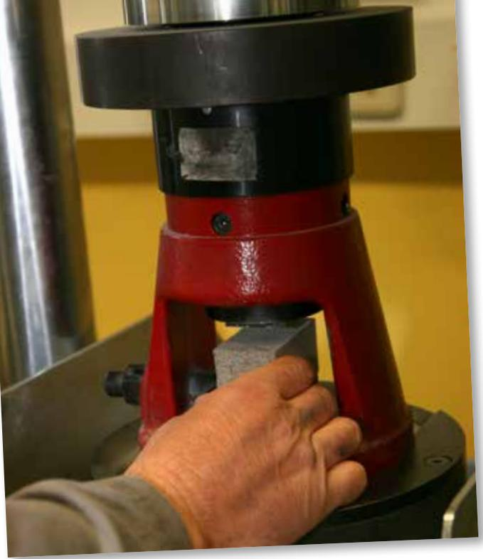
Druckfestigkeitsprüfung nach 28 Tagen (Abb. links und rechts)
