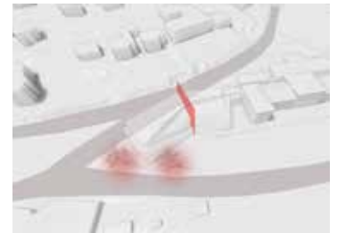
Rücksichtnahme auf die lokalen Bedingungen durch Aufnahme von Fluchtlinien und Eingliederung in den erhaltenswerten Baumbestand ergibt Knickachse im Baukörper
