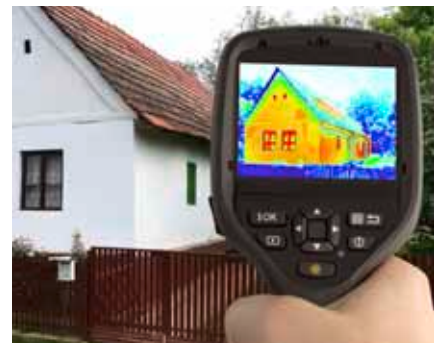
Eine Wärmebildkamera wandelt Wärmestrahlung in sichtbares Licht um.
