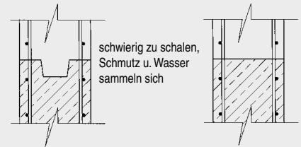
Grafik 4-16: Probleme bei Abwinkelungen in Arbeitsfugen
