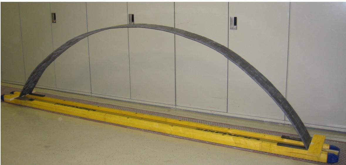
Abbildung 1: Vorgespannter Bogen aus 39 gekrümmten Einzelelementen
