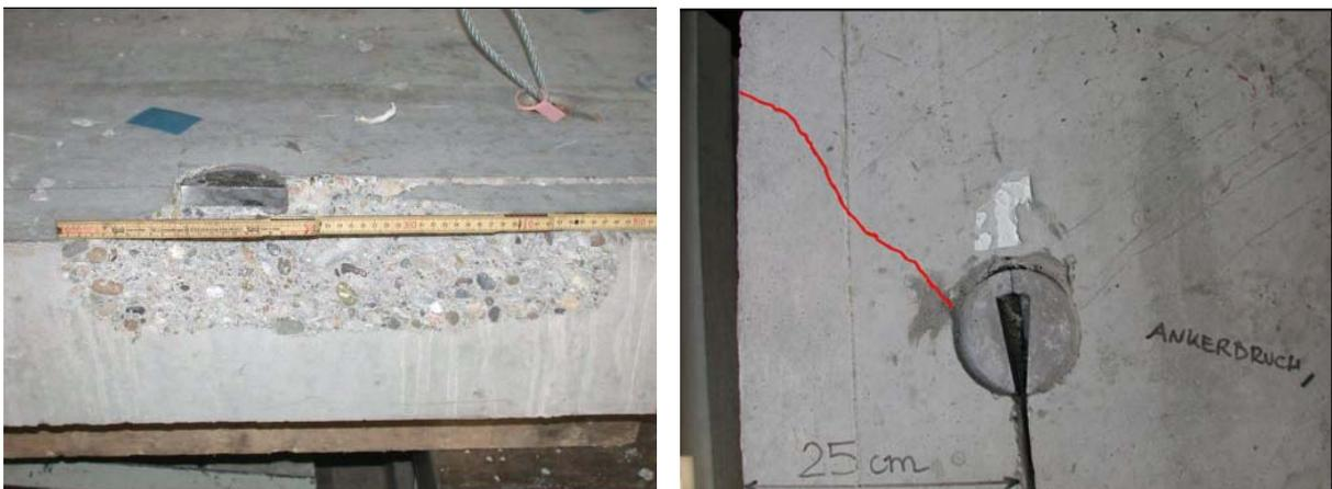
**Abb. 5:** Versuche mit Einfluss eines freien Bauteilrandes
