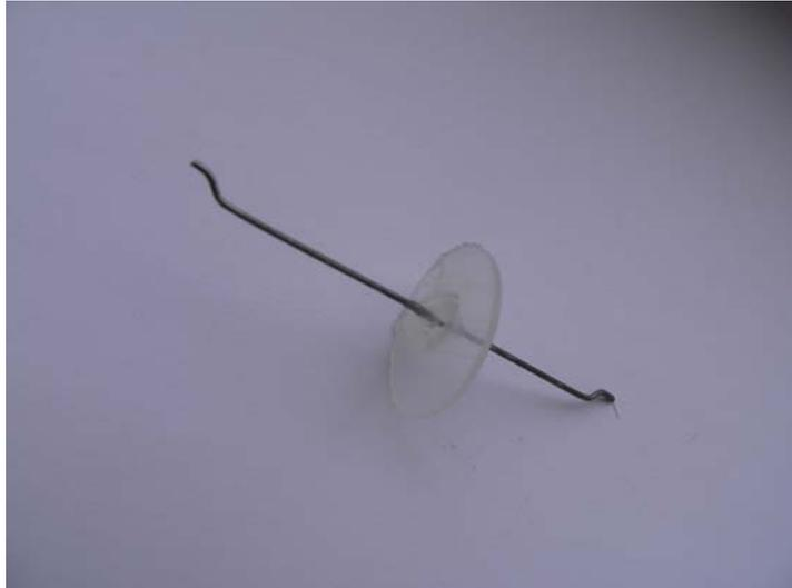
Abbildung 1: Faseraktivator mit gekröpfter Faser und Polypropylenplättchen.
