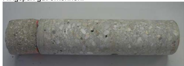
(Bild 6: Bohrkern)
