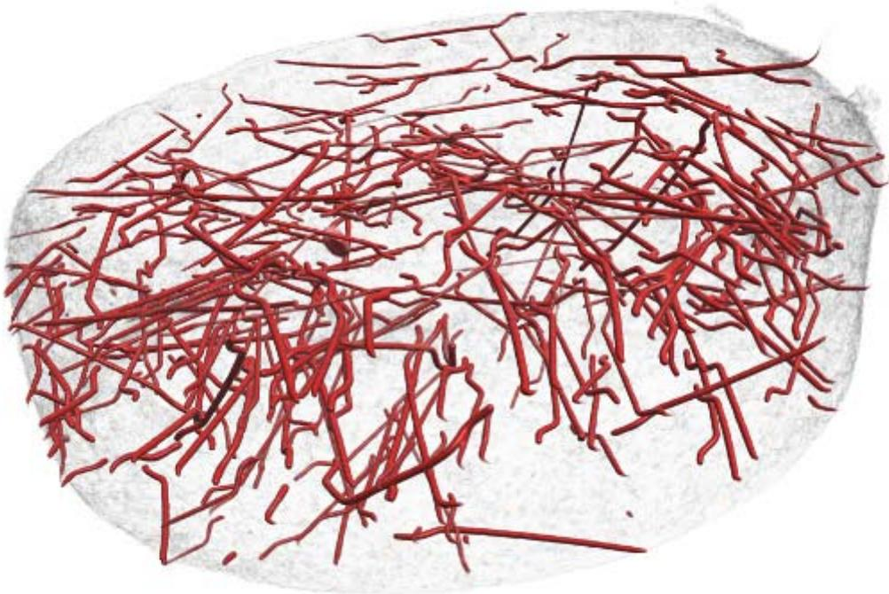
Bild 4: Stahlfaserbewährter Betonprobe
