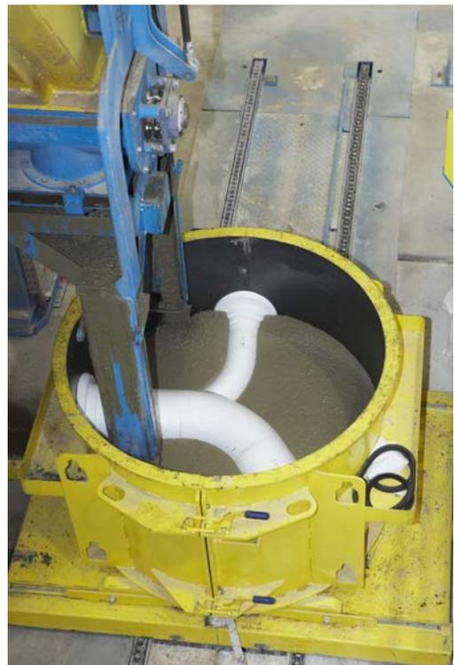
Bild 1: Fertigung eines Betonkammerbodens mit Selbstverdichtendem Beton
