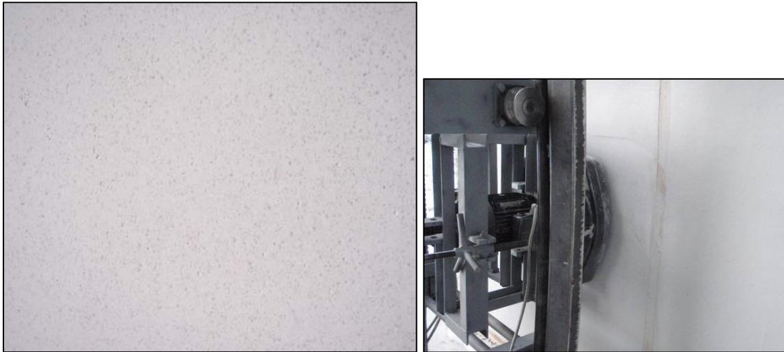
Abbildung 4: Detailaufnahme Oberfläche geschliffener weißer Spritzmörtel; Schleifkopf
