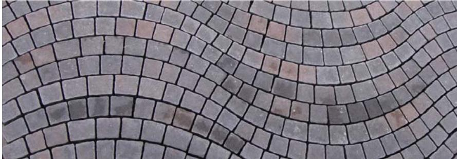
Ein Bogen hat einen Innenradius von 120 cm, durch das Verlegen von 1 - 4 Ergänzungssteinen ist das Bogenmaß schrittweise auf bis zu 153 cm erweiterbar. Für den Randabschluss, der in der Mitte des Bogens erfolgt, sind die Ergänzungssteine perfekt dimensioniert. Als Erweiterung wurden noch spezielle Links- und Rechts-Bögen entworfen, mit denen sowohl Kurven als auch ganze Kreise verlegt werden können. Der kleinste Innenradius beträgt auch hier wiederum 120 cm.
