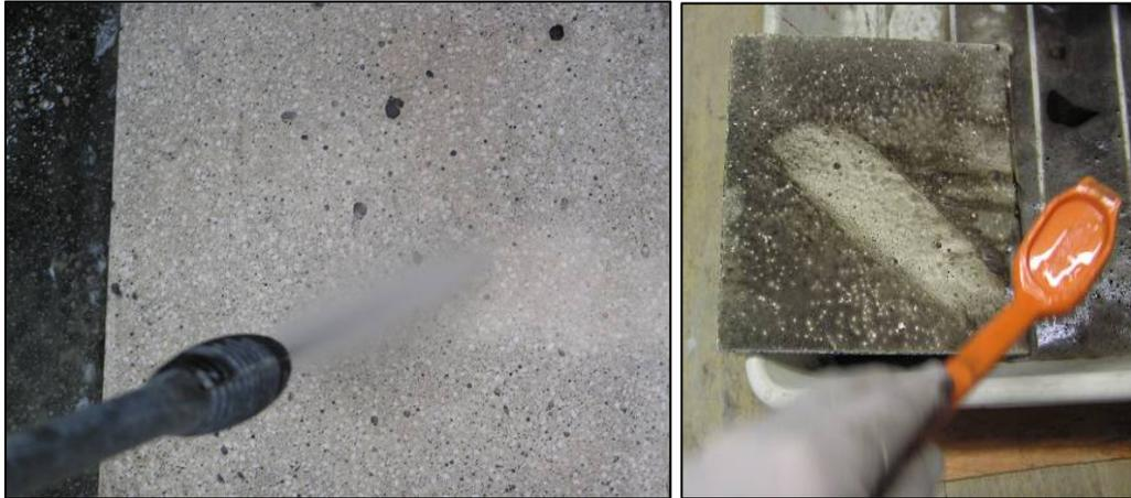
Abbildung 2: Reinigung der Probekörper
