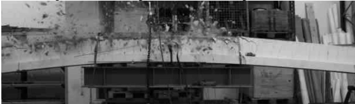
Abb. 3: Großversuch, Abplatzen der Betondeckung bei eingeschlizten Lamellen ohne Vorspannung.
