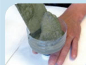
Nach Abschluss der Arbeit muss der Beton vor dem Austrocknen geschützt werden. Lege dazu ein feuchtes Tuch oder Papier über den Betonkörper und stülpe darüber den leeren Sand-Kunststoffbeutel und lass den Betonkörper mindestens 3 Tage lang bei Raumtemperatur aushärten.
