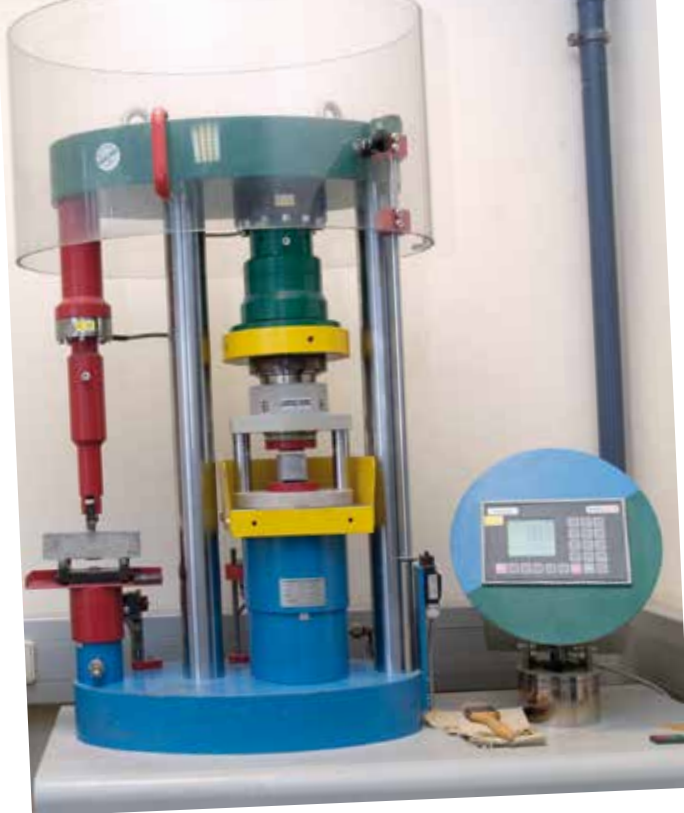
Druckfestigkeitsprüfung nach 28 Tagen (Abb. links und rechts)
