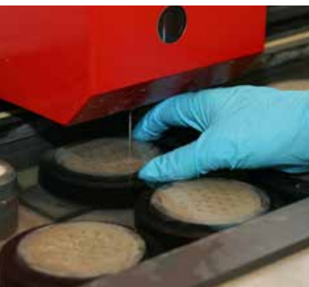
Prüfung des Abbindezeitpunktes
