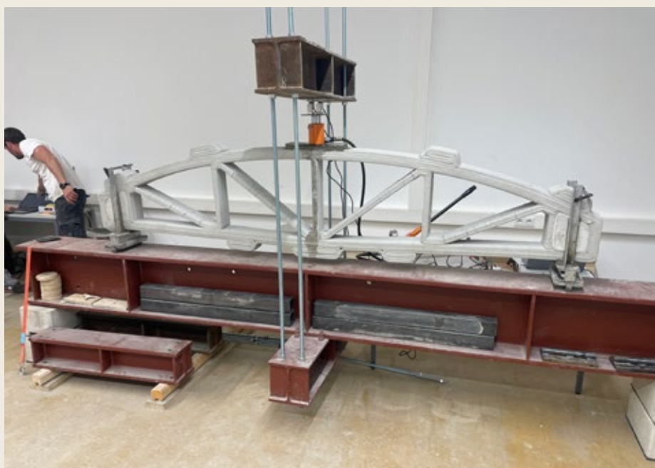
Praxistest bestanden: 3D-gedruckte Bauteile inklusive Bewehrung
