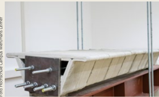
Ein Forschungsteam untersucht das Trag- und Verformungsverhalten 3D-gedruckter Betonbauteile, z. B. als Betonfachwerk bzw. als vorgespannter Träger.
