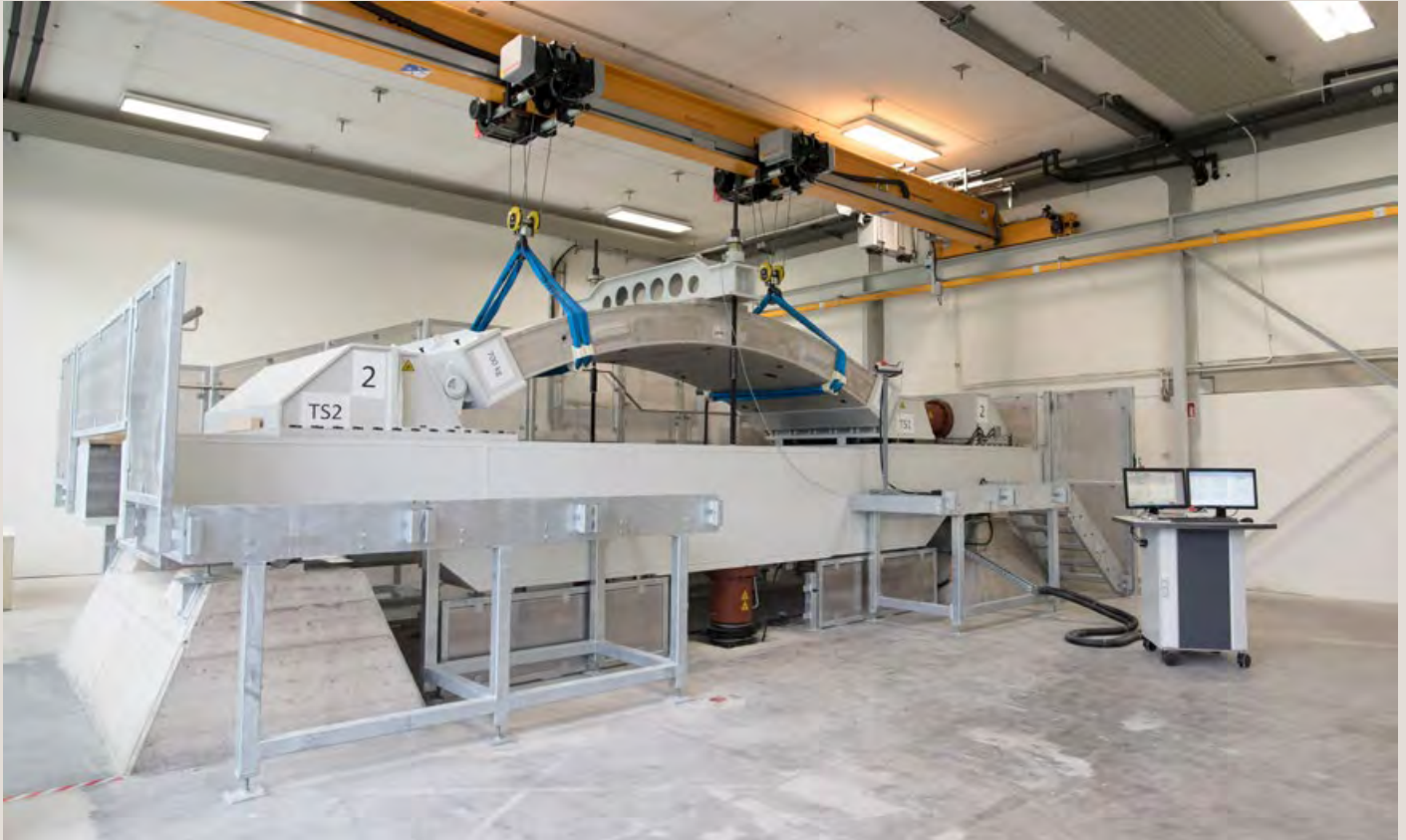
Tübbing-Prüfstand der Montanuniversität Leoben
