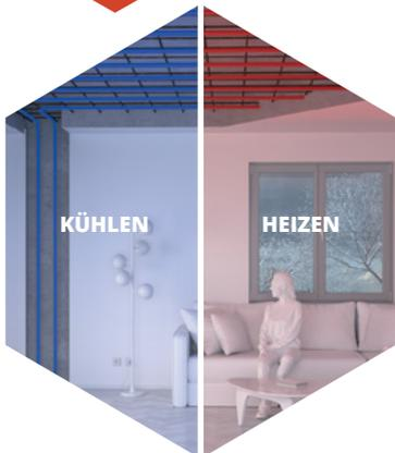
Die Bauteilaktivierung macht Decken und Wände aus Beton zum perfekten Energiespeicher. So kann erneuerbare Energie das ganze Jahr zum Heizen und Kühlen genutzt werden. Das bringt mehr Komfort und weniger Energiekosten.
