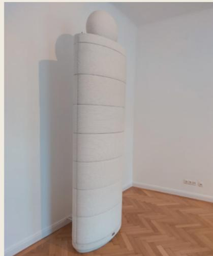
Bauteilaktivierte 3-D-Betondruckteile liefern eine angenehme Strahlungswärme.
