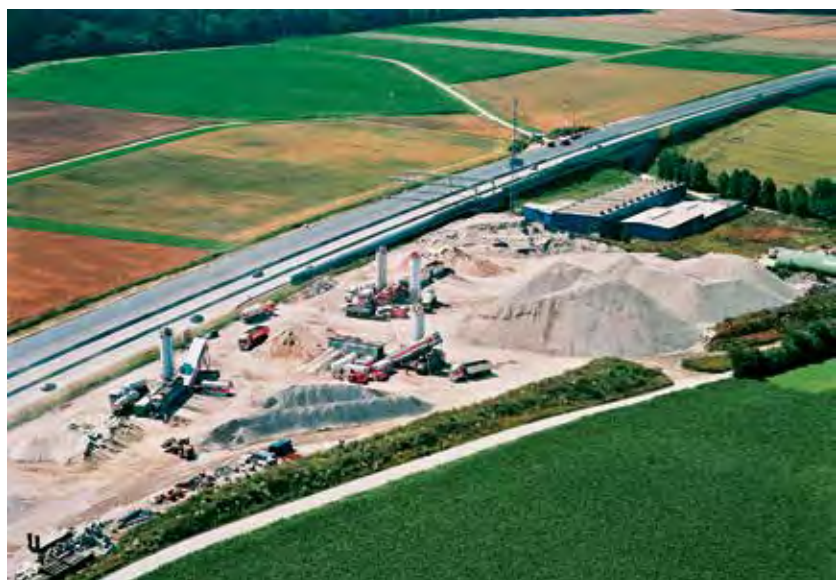
Abb.6–1: Ökologischer und ökonomischer Vorteil durch räumliche Nähe von Gewinnungsstätte, Aufbereitung und Wiederverwendungsort (Foto Asamer Holding AG)
