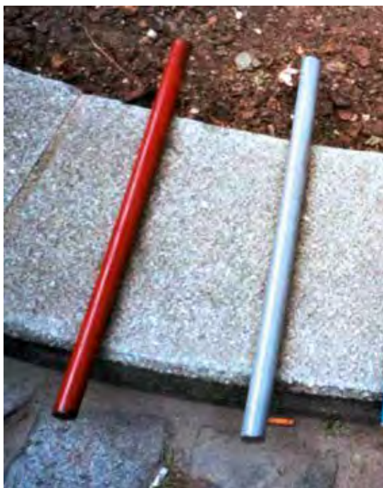
Abb.4–17: Stahldübel mit Korrosionsbeschichtung
