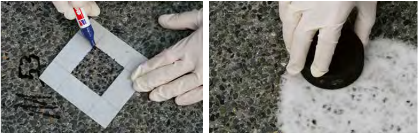
Abb.5–16: Bestimmung der Profilspitzenanzahl sowie Bestimmung der Rautiefe (Fotos VÖZfi)
