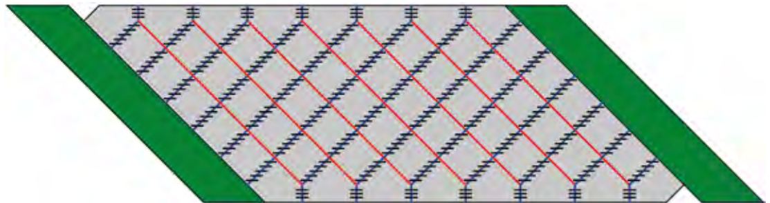
Abb.8-33: Zur Hauptdehnungsrichtung parallel ausgerichtete Dübel
