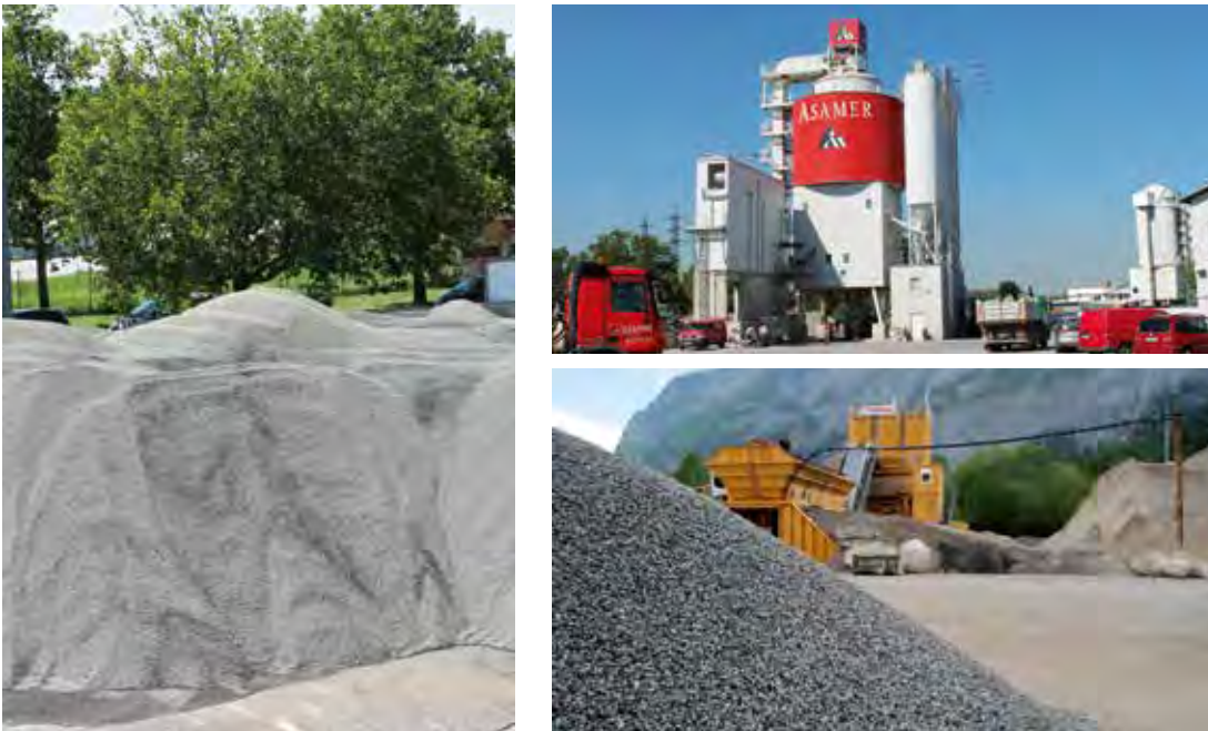
Abb.5–1: Lagerung der Betonausgangsstoffe sowie Mischanlagen (VÖZfi, ASFINAG)
