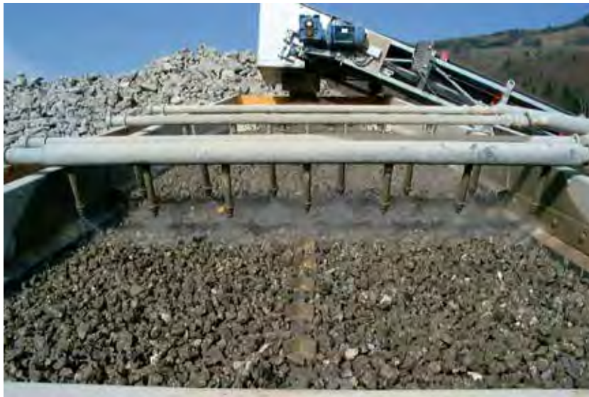
Abb.6-4: Sieben und Waschen der Recyclingkörnungen (Foto Asamer Holding AG)
