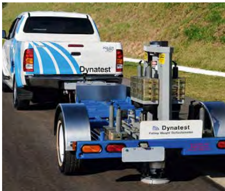
Abb.9–6: Dynamisches Fallgewichtsgerät FWD und Messprinzip zur Tragfähigkeitsbeurteilung
