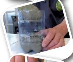
Fülle nun langsam etwas Beton in den Flaschenunterteil (bis ca. 2 cm Höhe). Den Beton durch leichtes Stoßen des Gefäßes auf der Tischplatte verdichten, bis keine Luftblasen mehr aufsteigen.
