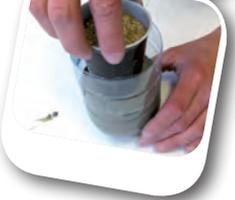
Danach die nächste Schicht (wieder ca. 2 cm) einfüllen und verdichten. Wiederhole dies solange, bis du die Markierung erreicht hast. Anschließend den Trinkbecher (mit Sand gefüllt) langsam und unter leichtem Stoßen auf der Tischplatte in die Mitte hineindrücken. Etwa 2 cm des Bechers sollten am Schluss noch aus dem Beton ragen.
