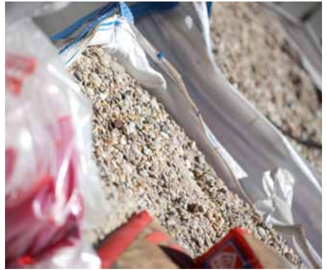
Abb. 6: Gesteinskörnung in verschiedenen Größen verwenden – Sie können nach Größtkorn bestellen.
