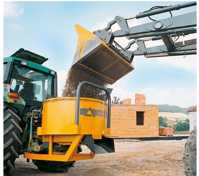
Abb. 11: Zwangsmischer weisen meist einen Nenninhalt über 500 l auf. Der Antrieb über den Traktor erzielt gute Mischergebnisse.
