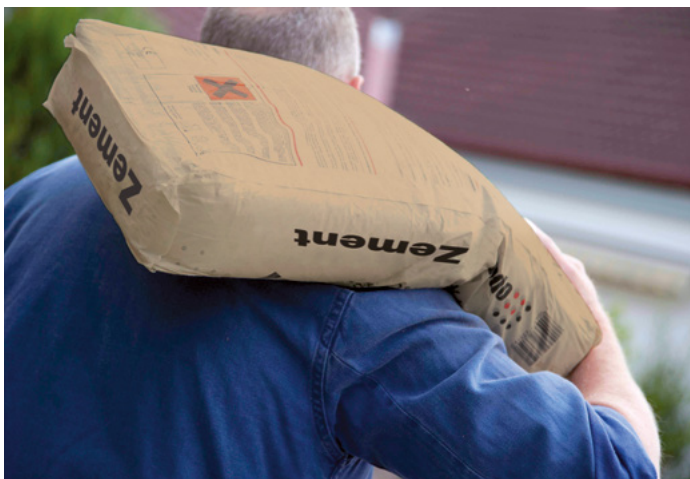
Abb. 2: Zur leichteren Handhabung ist das Sackgewicht bei Zement auf 25 kg festgelegt.
