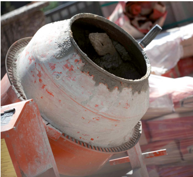
Abb. 10: Freifallmischer für kleine Betonmengen
