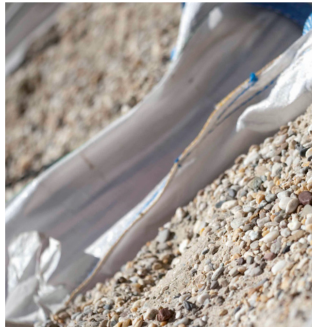
Abb. 6: Gesteinskörnung in verschiedenen Größen verwenden – bestellt wird nach Größtkorn.
