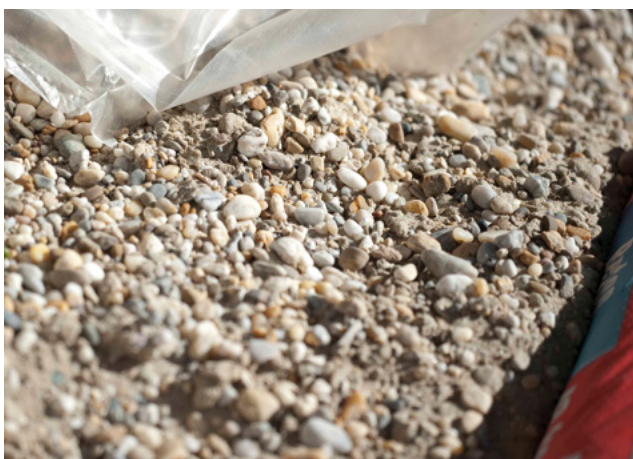
Abb. 12: Die Gesteinskörnung sollte nicht der direkten Sonneneinstrahlung ausgesetzt sein (Sonnendächer, Matten, Planen).
