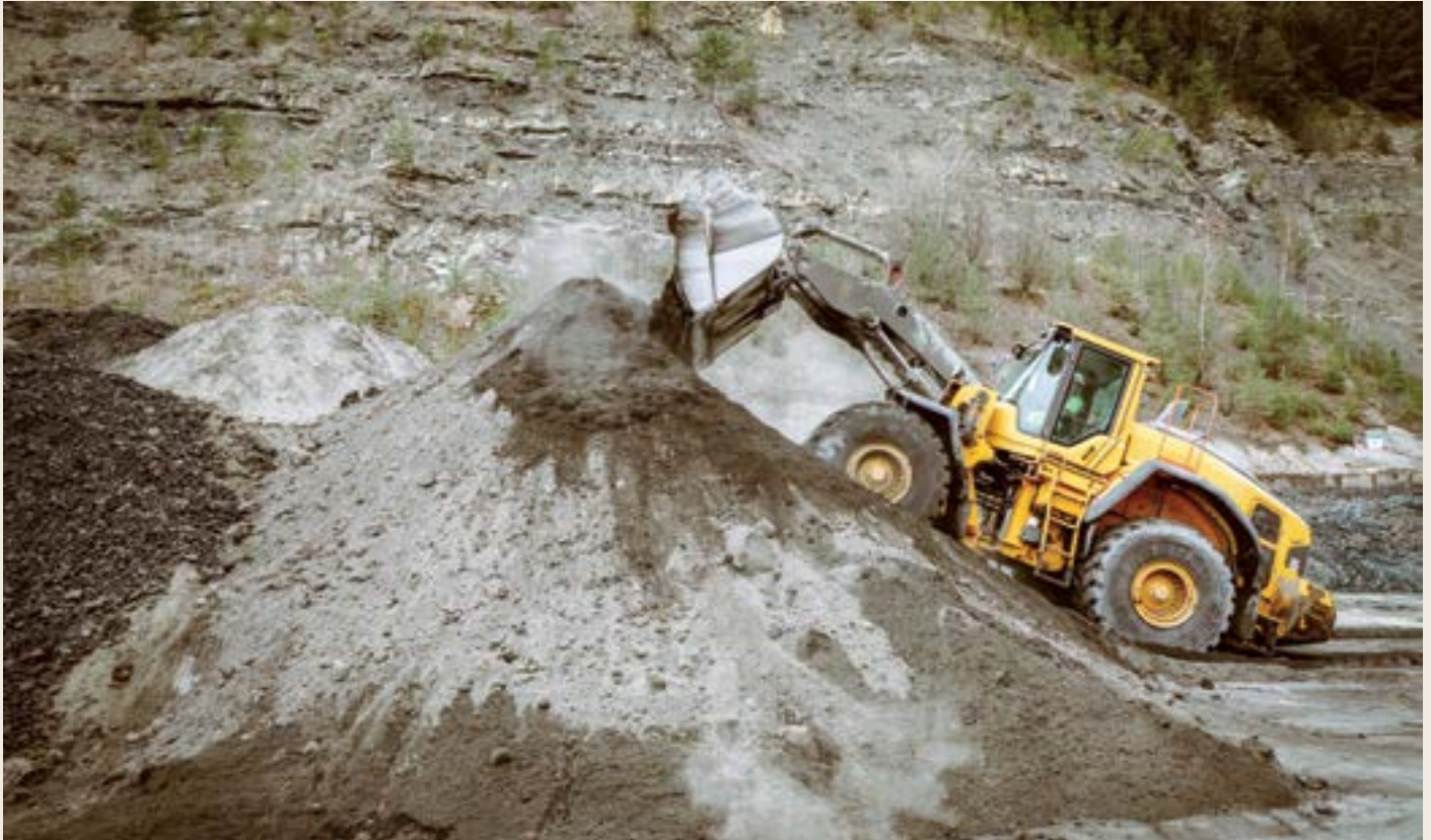
Aufbereitung der Ersatzrohstoffe für den Prozesseinsatz.
