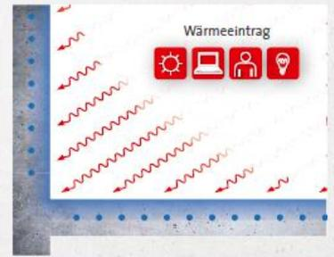
Überschüssige Wärme wird von den Betonbauteilen aufgenommen und abgeführt.
