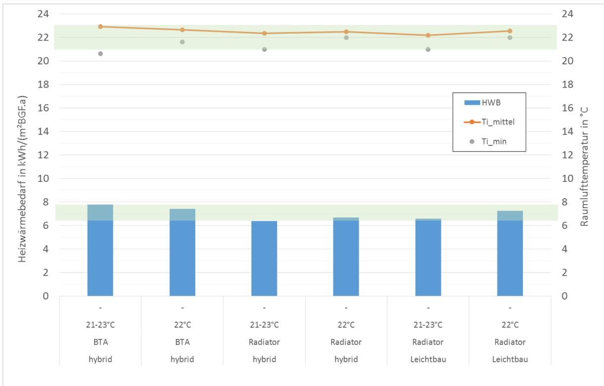
Abbildung 4-2 Wärmebilanzen über die Heizperiode für das MFH
