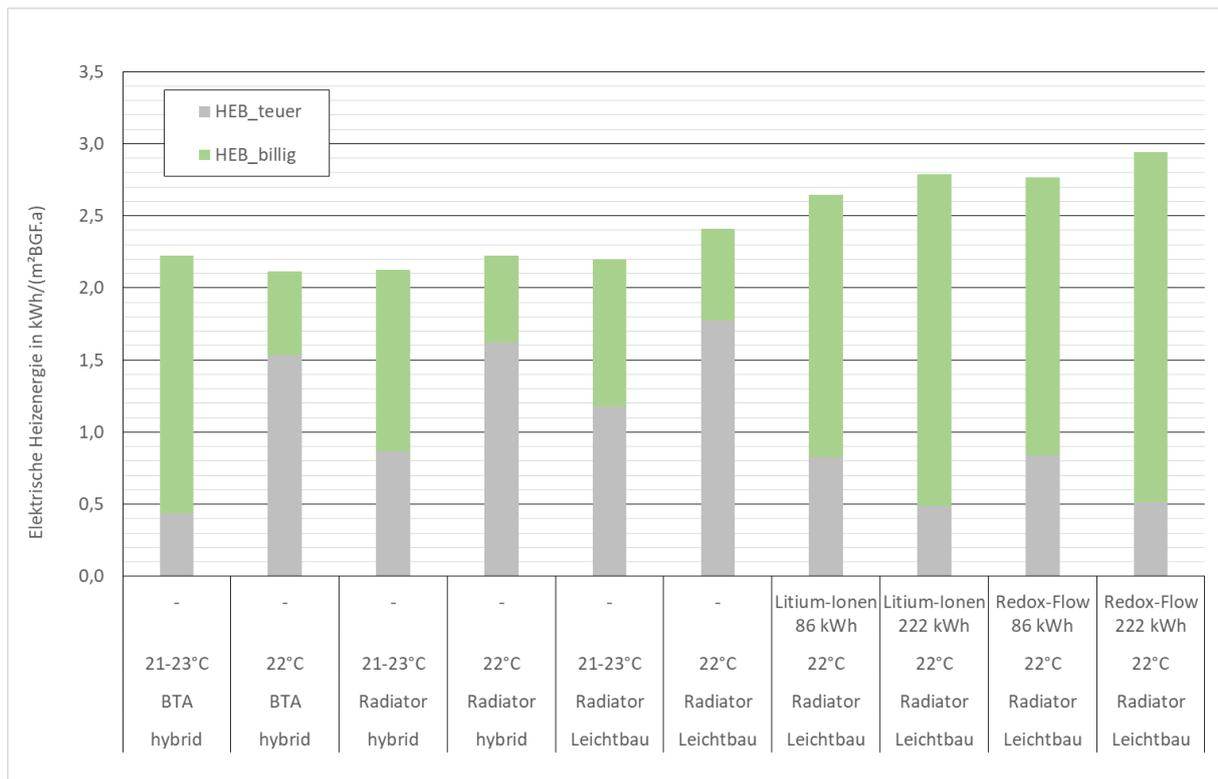
Abbildung 4-4 Strombedarf (HEB) der Varianten des MFH gegliedert nach Wind- und Netzstrom
