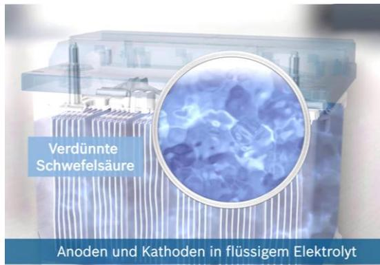
**Abbildung 6-12:** Spezifischer Aufbau einer Blei-Säure-Nass-Batterie
