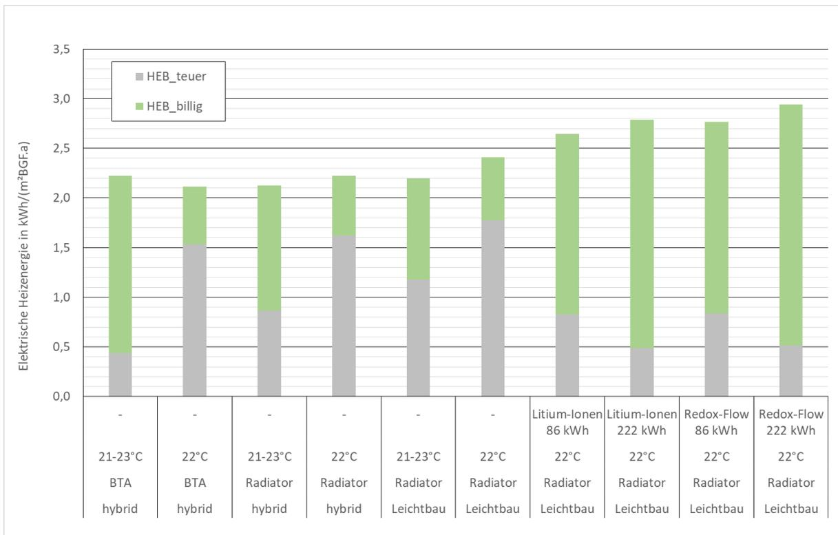
Abbildung 1-4 Strombedarf (HEB) der Varianten des MFH gegliedert nach Wind- und Netzstrom
