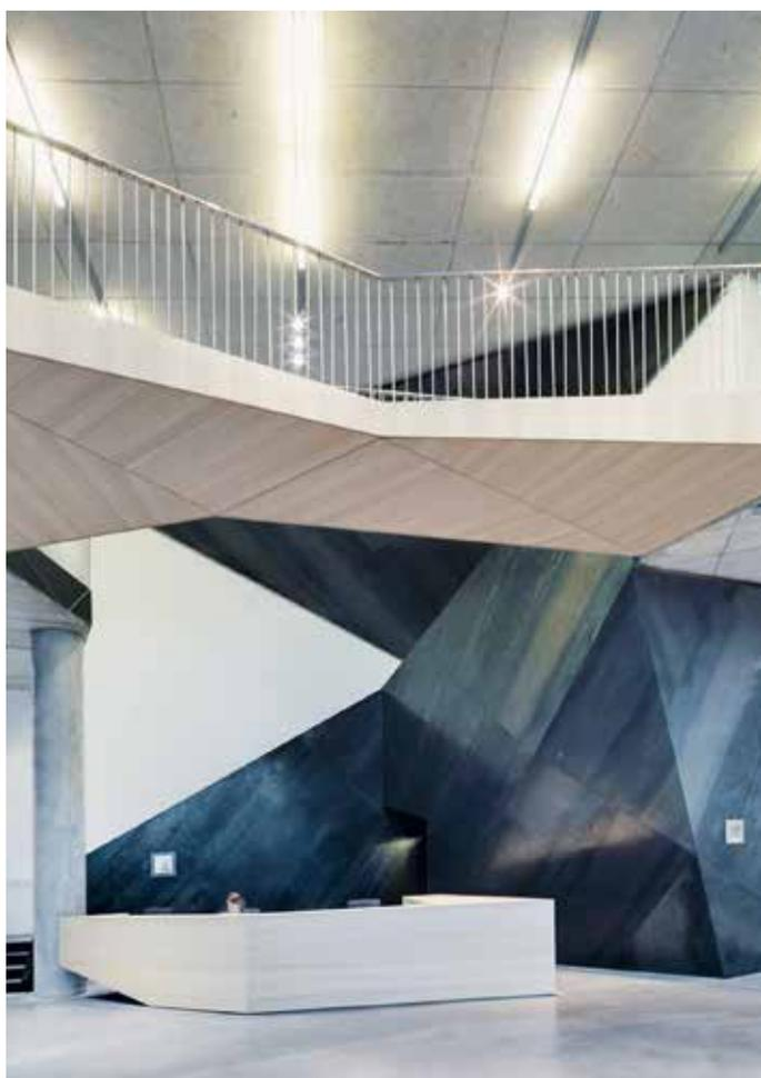
leicht abgekühlt. Diese „Aktivierung“ der Decken führt zu einem sehr großen Wärme- und Kältespeicher, der die Überhitzung im Sommer und die schnelle Auskühlung im Winter vermeidet und einen natürlichen Tagesverlauf der Temperatur im Raum mit sich bringt.
