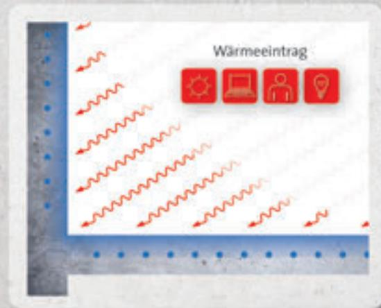
Überschüssige Wärme wird von den Betonbauteilen aufgenommen und abgeführt.
