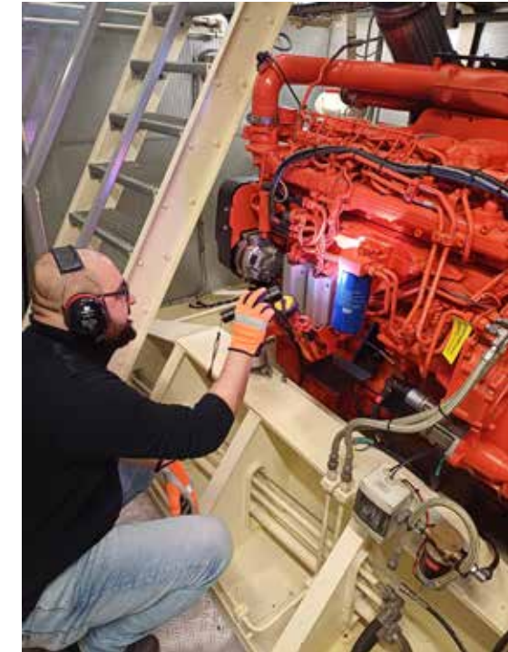
Ein beliebter Ansatz zur Emissionsreduktion: Alternative Kraftstoffe ohne Umrüstungsbedarf. Auch das viadonau-Schiff Bad Deutsch-Altenburg fährt seit 2023 im Testbetrieb mit HVO100.
