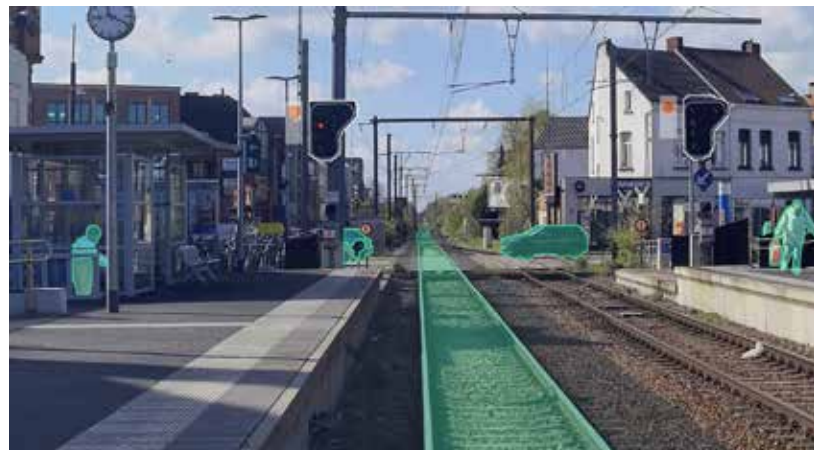
Die sichere AI beim autonomen Zugfahren zeigt mit grün an, ob die Strecke frei ist
