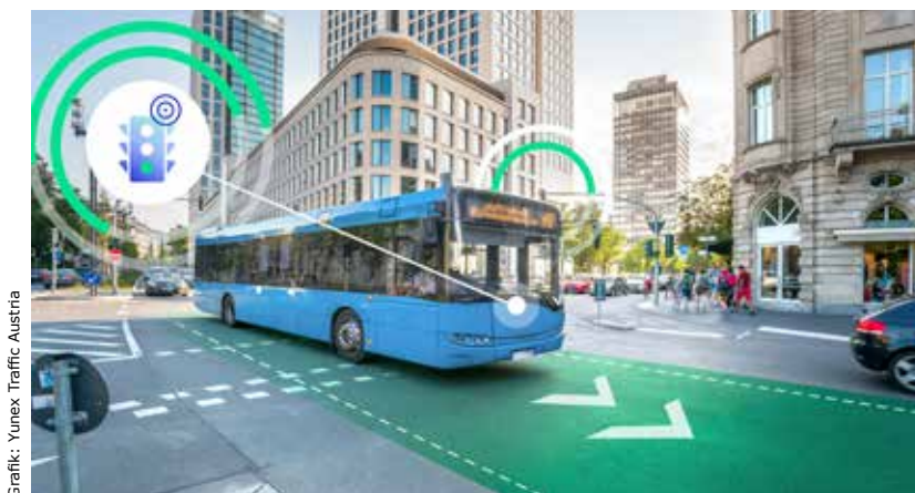
Die zukünftige linienhafte Erfassung der Fahrzeugpositionen im Zulauf zu Lichtsignalanlagen über C-ITS bietet deutlich mehr Flexibilität und Steuerungspotenzial
