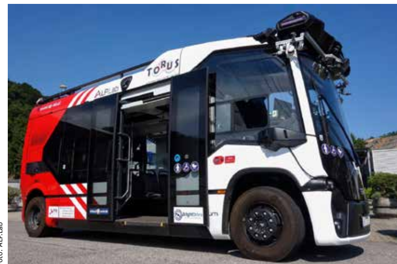
TORUS ist ein batterieelektrischer, hochautomatisierter Bus, konzipiert, um neue automatisierte Mobilitätssysteme in den Regelbetrieb zu überführen.
