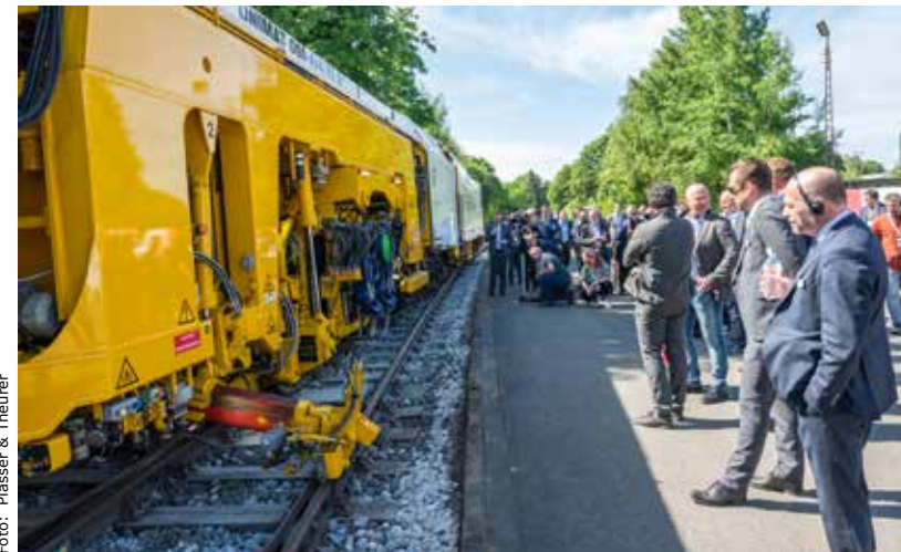
„Nur Zuschauer“ – kein Bedienpersonal. Weltneuheit auf der iaf 2025: Live-Demonstration des autonomen Stopfens mit dem Unimat 09-4x4/4S E 3
