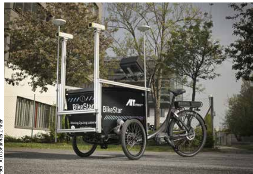
Das Messfahrrad ist mit 3D-Kameras, LiDAR-Laserscanner, Koppelnavigation, Inertialsensoren und Temperatursensorik ausgestattet.
