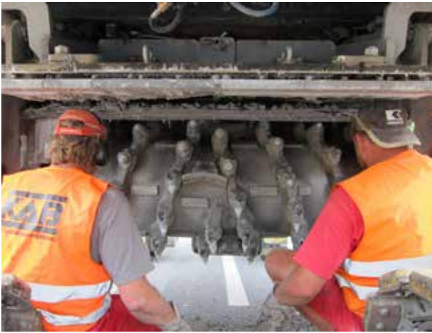
Abb. 2 Fräskopftausch bei der Fräse, Arbeitsbreite 2,2 m
