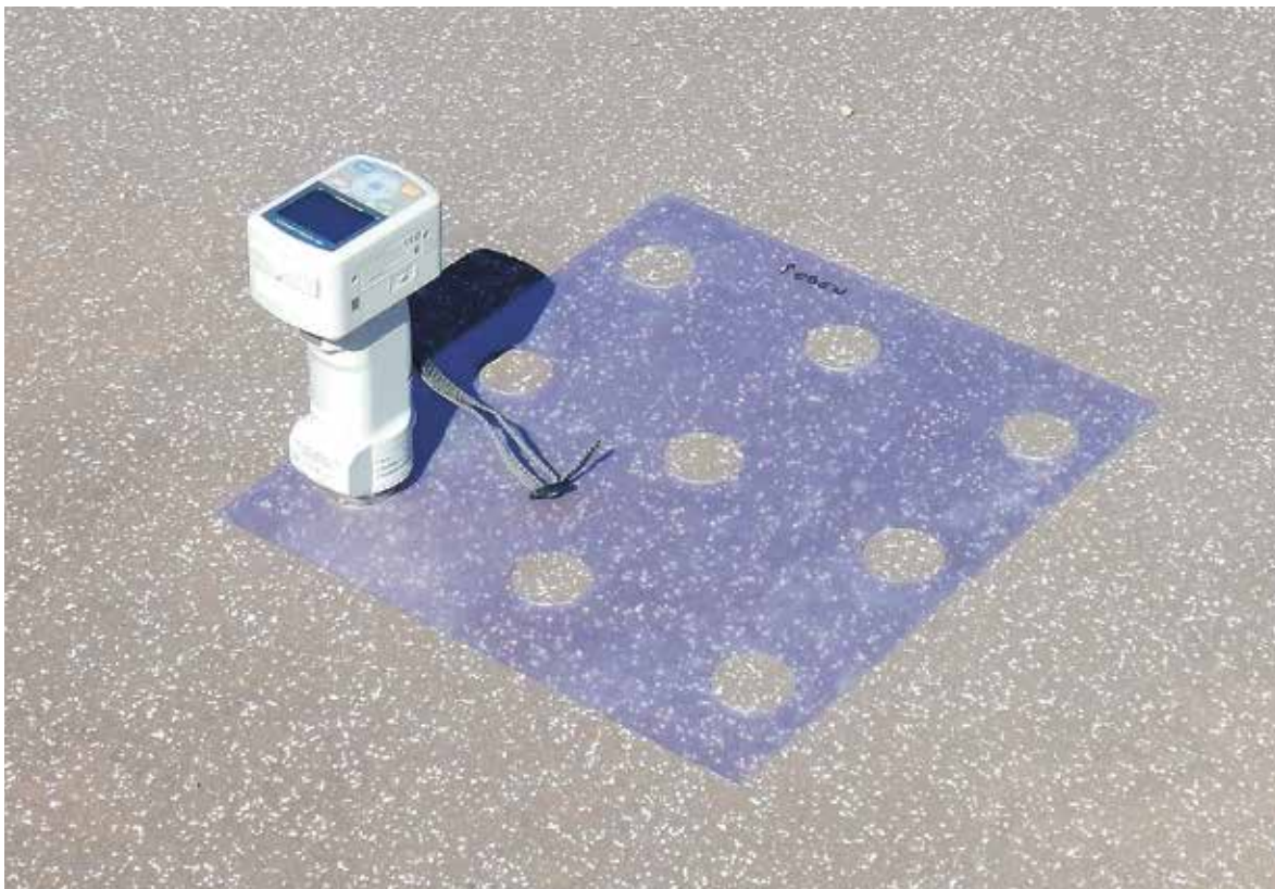
Abbildung 10: Messanordnung zur Ermittlung des Reflexionsgrades
