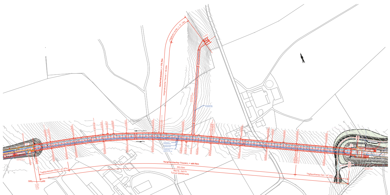
Schema des Tunnels Stättlerwald mit dem rechtwinklig zulaufenden Sicherheitsstollen. Grafik: IG UCH Cham+
