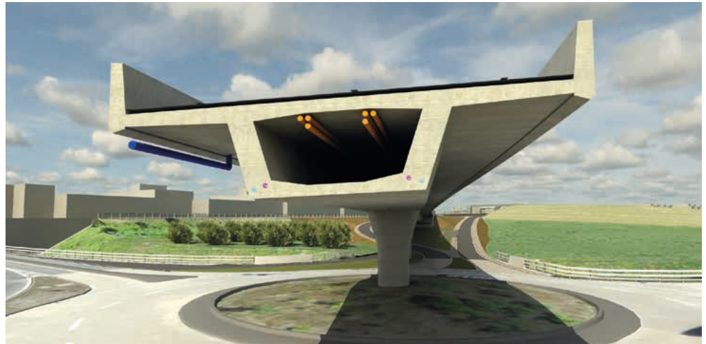
Querschnitt durch die Hohlkastenkonstruktion der Gibelfeldbrücke Grafik: IG UCH Cham+
