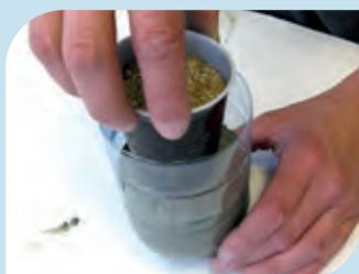
Anschließend den mit Sand befüllten Kunststoffbecher langsam und unter leichtem Stoßen auf der Tischplatte mittig in den Frischbeton hineindrücken, bis der Trinkbecher noch ca. 2 cm aus dem Frischbeton ragt. Danach den Frischbeton nochmals, wie oben beschrieben, verdichten und dabei darauf achten, dass sich der Trinkbecher möglichst senkrecht und genau in der Mitte der PET-Flasche befindet.
