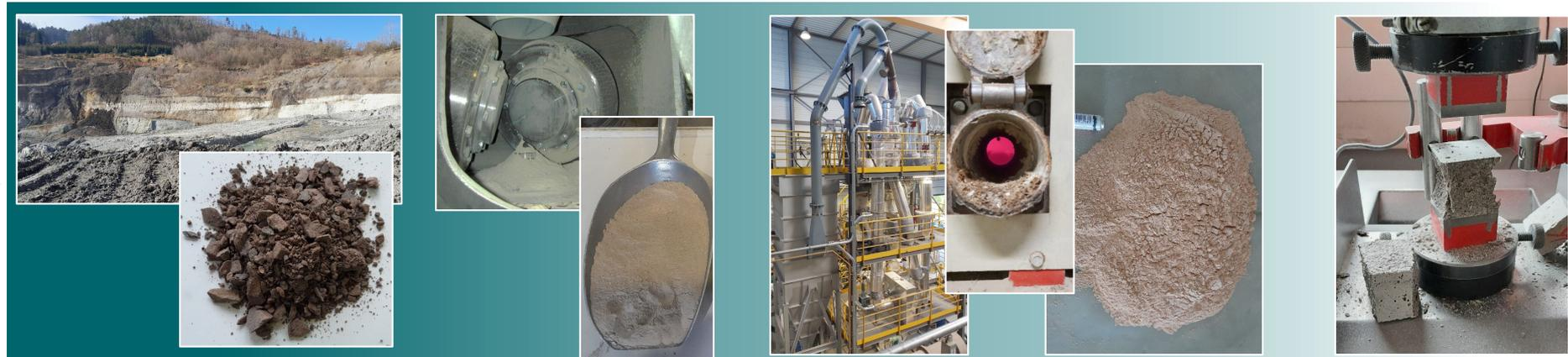
Tonrohstoff → Mahltrocknung (ggf. weitere Aufbereitung) → „Aktivierung“ durch Tempern (Flashreaktor) → Klinkerersatz
