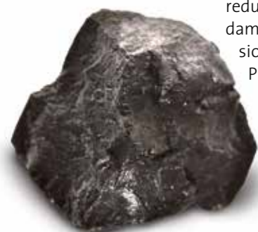
Aus Plankton wird Ölschiefer: Jahrmillionen später ein guter Ersatzrohstoff, der den Klinkeranteil im Zement reduziert.
