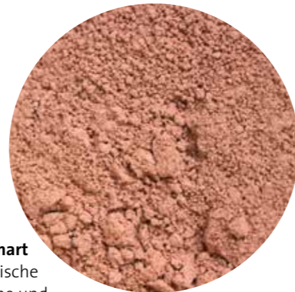
Klimafitte Mischung: Getemperte Tone können Klinker zum Teil ersetzen und geben beim Brennen kein CO 2 ab.
