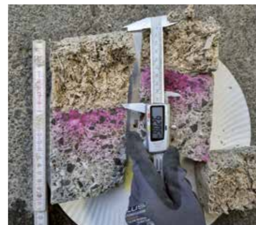
Wie weit geht Gas? Bei der Smart Minerals GmbH wurde erforscht, wie gut neu errichtete und bestehende Lärmschutzwände CO 2 aufnehmen.
