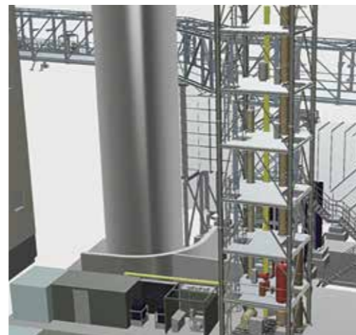
Rauchgase bitte hier abbiegen: Neben dem neuen Kamin samt Schlauchfilteranlage zur Lärm- und Geruchsminderung wird im Zementwerk Hatschek auch an der Abscheidung von CO 2 getüftelt.
