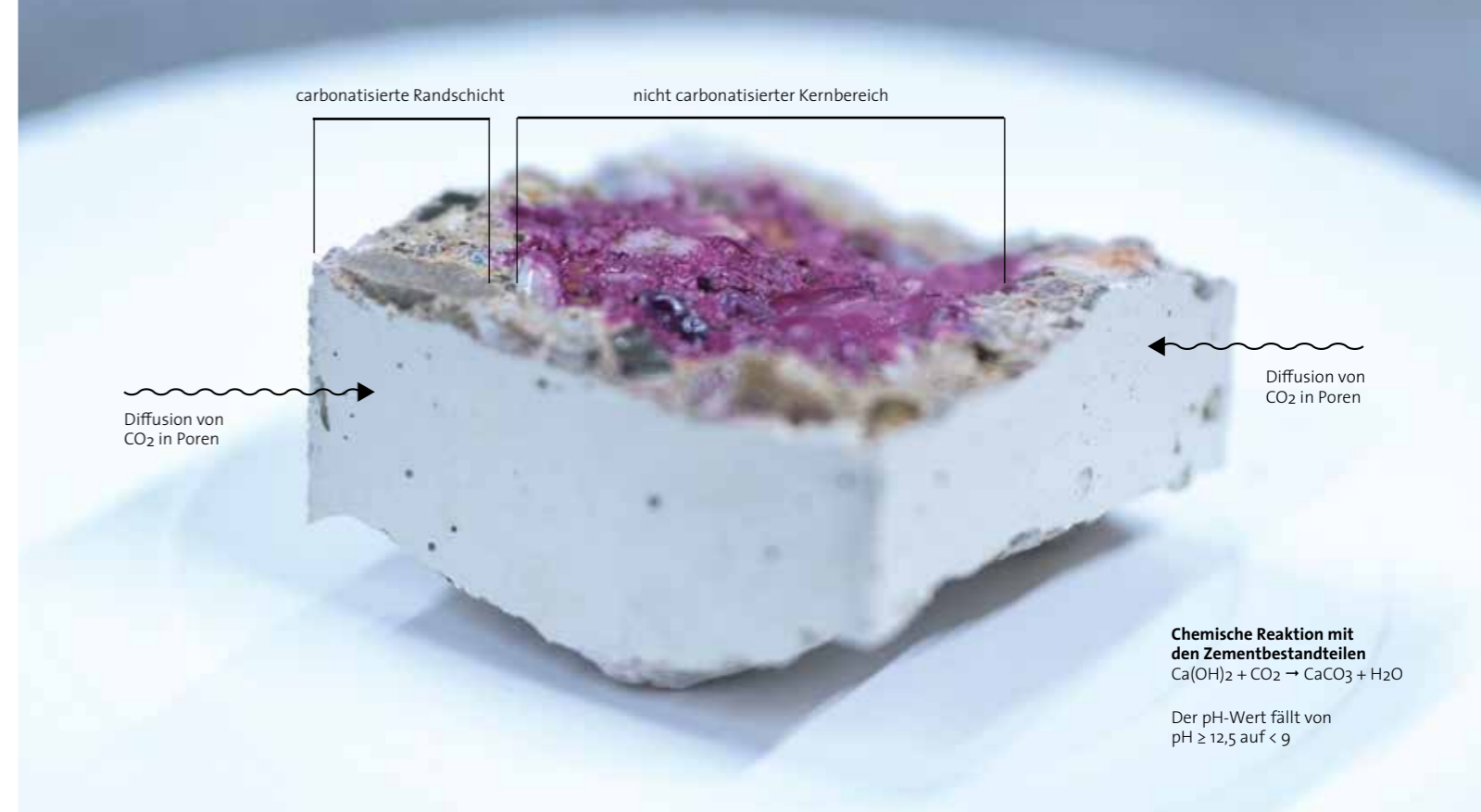
In Beton gebunden: Die Carbonatisierung ist eine natürliche chemische Reaktion von Beton mit CO 2 aus der Umgebungsluft – das Gas wird bis zu einem gewissen Grad aufgenommen und eingelagert.
