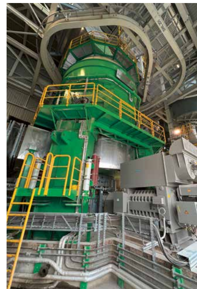
Die kriegt alles klein: Die neue vertikale Rohmühle in Mannersdorf bereitet das Rohmehl für den Brennprozess auf.
