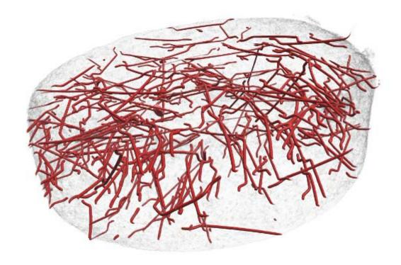
Bild 4: Stahlfaserbewährter Betonprobe
