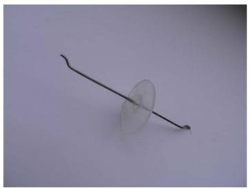
Abbildung 1: Faseraktivator mir gekröpfter Faser und Polypropylenplättchen.
