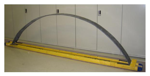
Abbildung 1: Vorgespannter Bogen aus 39 gekrümmten Einzelelementen
