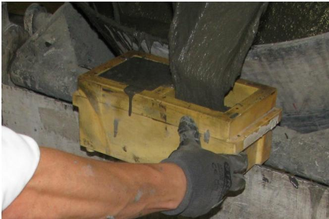
Abbildung 1: UHPFRC beim Einfüllen in eine Würfelform
