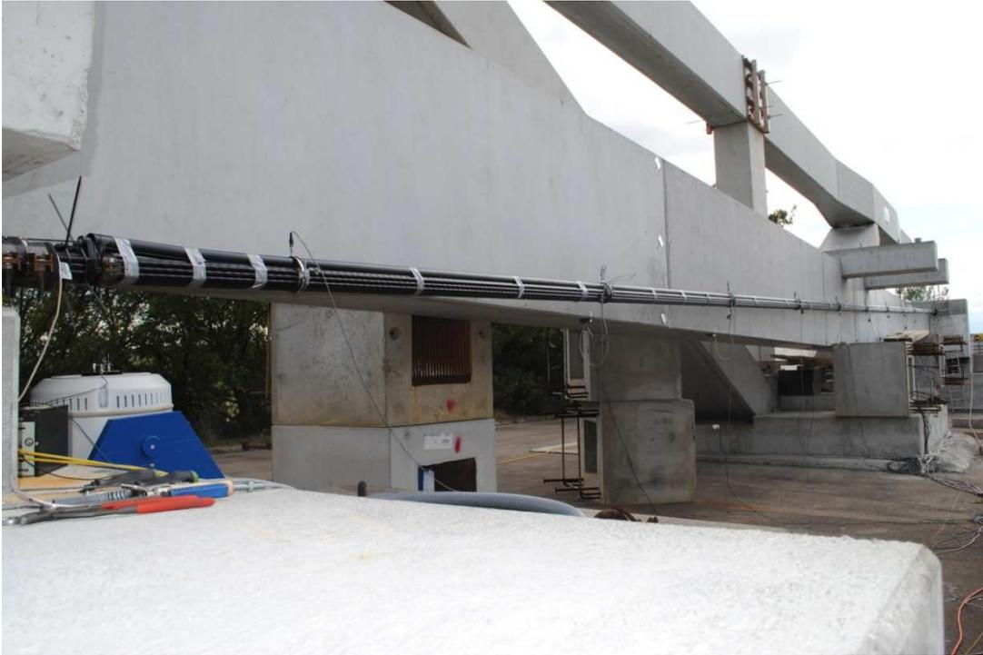
**Bild 1: Versuchsaufbau mit integriertem Dämpfungssystem**
