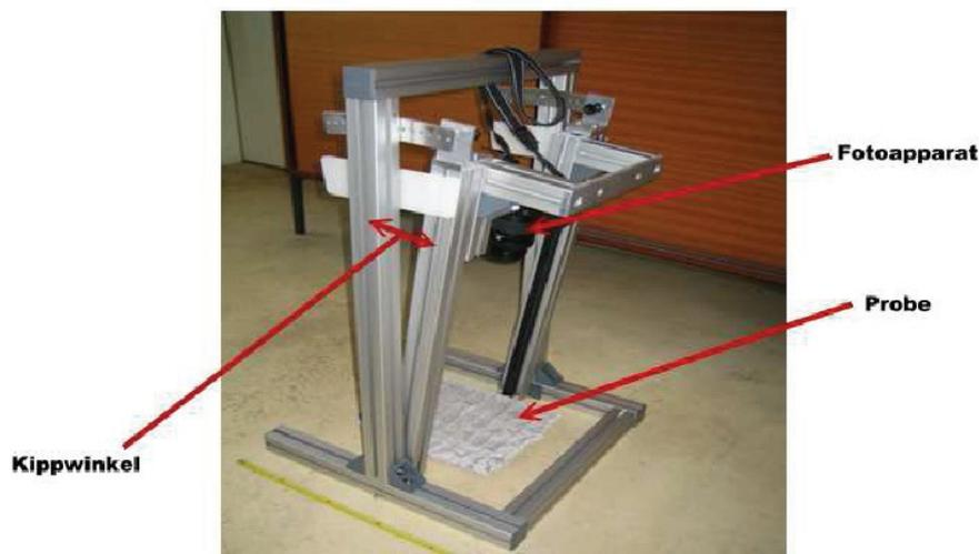
Abbildung 1: Vorrichtung zur Oberflächenanalyse
