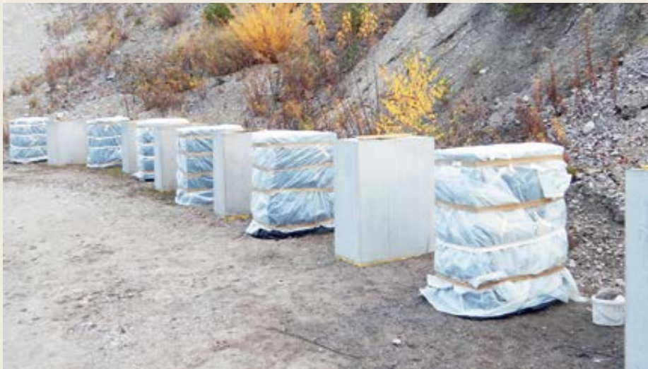
Versuchswände mit unterschiedlichen Nachbehandlungsvarianten: V1: reine Betonkörper, die Probekörper wurden nach 24 Stunden ausgeschalt, dann erfolgten keine weiteren Maßnahmen; V2: die in Folie eingepackten Probekörper, die nach 36 Stunden ausgeschalt wurden und eine Nachbehandlung erhielten, mit Abdeckung einer Folie. Siehe dazu auch Tabelle 2.
